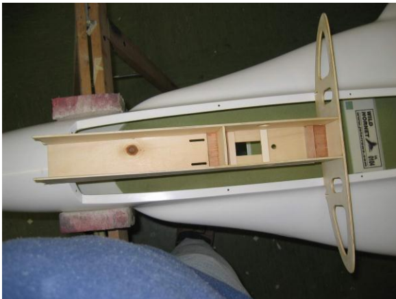
Obrázek 8 Slepená přední část přepážek připravená k montáži
